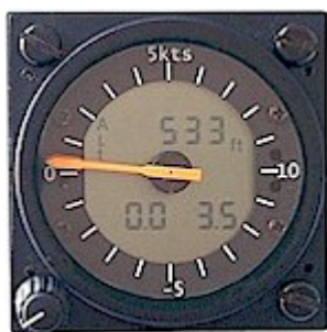
Fig. 5: Cambridge 302, um variómetro digital com logger FAI integrado.
